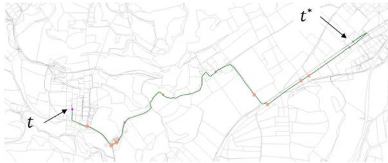
Abbildung 19. Trassierung für den Kabelauslass Cmp_EVNt_011_00095 bis zum Versorgungszentrum der Instanz. Die Positionen der Kabelverzweigungen (mittels Abzweigmuffen) sind durch orange Quadrate markiert.
