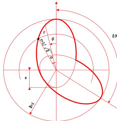
Der halbe Wert des Winkels bei dem die abgestrahlte Leistung auf den halben Wert reduziert wird, kann innerhalb des Bereiches von 15 bis 60 Grad in 5-Grad-Schritten variiert werden.
