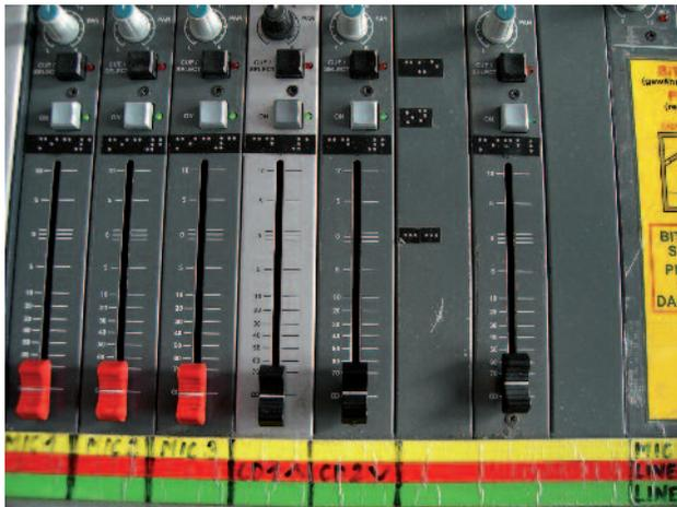
Abbildung 18: Mischpult mit Beschriftung in Brailleschrift
