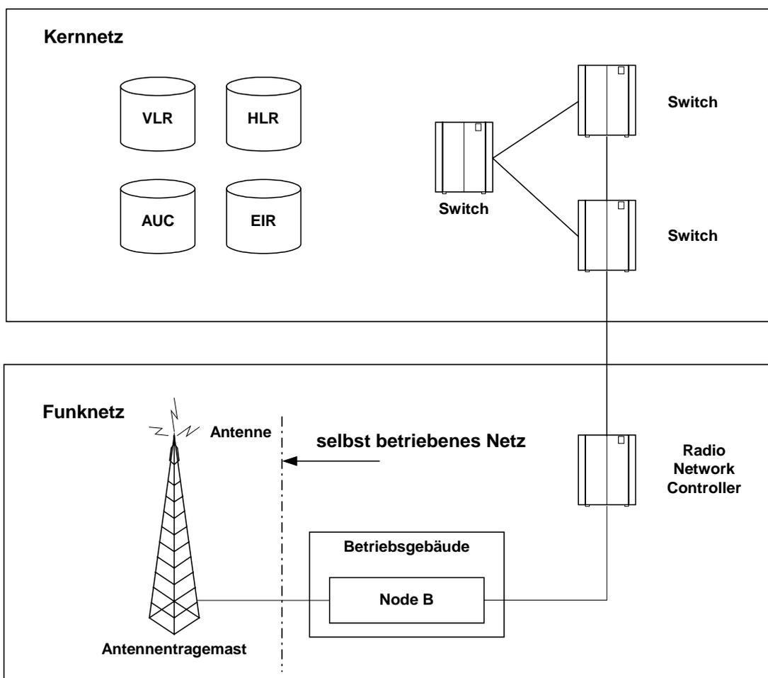
ABBILDUNG 1: AUFBAU MOBILFUNKNETZ
