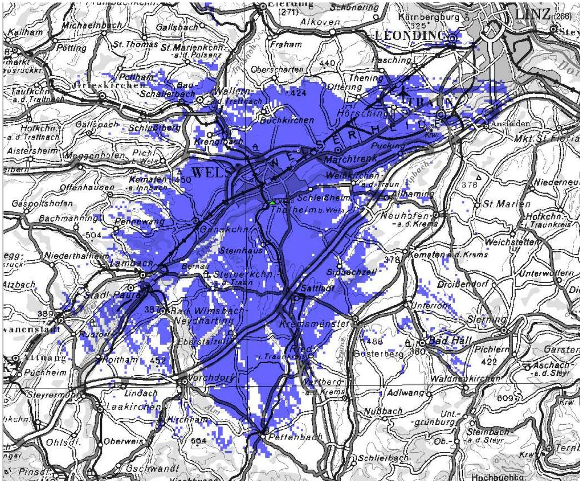
Bei dem markierten Bereich handelt es sich um ein berechnetes Versorgungsgebiet mit einer Mindestnutzfeldstärke von  $66 \text{ dB}\mu\text{V/m}$ , wobei die topographischen Gegebenheiten und mögliche Störsender berücksichtigt wurden. Laut ITU-Rec. 412 ist in bebautem Gebiet eine Feldstärke von mindestens  $66 \text{ dB}\mu\text{V/m}$  in 10 m Höhe notwendig, um eine ausreichende Versorgung sicherzustellen.
