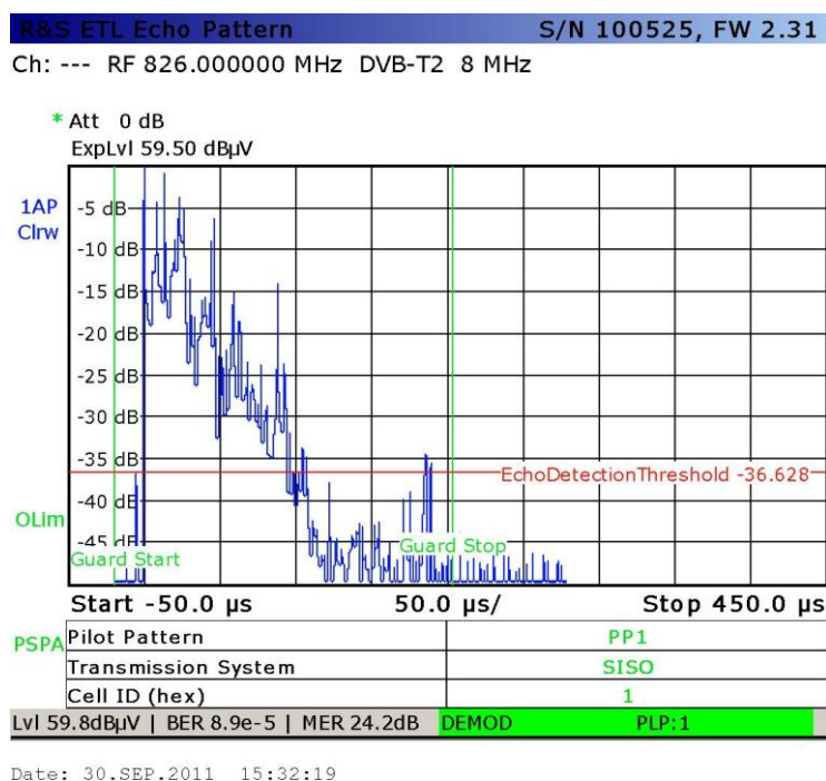
Abbildung 6: Reflexionsspektrum eines typischen Zimmerantennen-Empfangs
