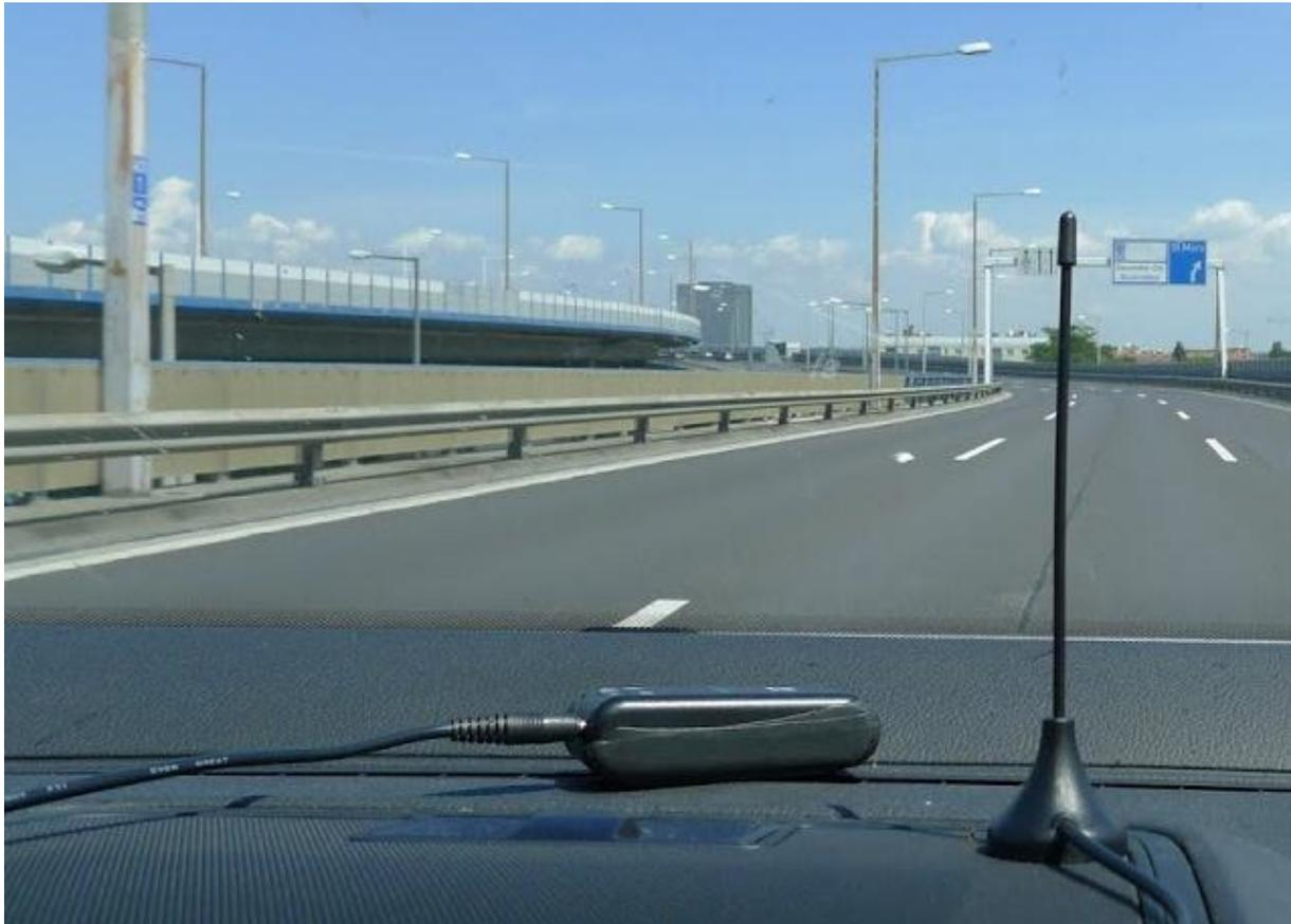
**Abbildung 11: Magnetfuß-Antenne für den DVB-T2 Empfang und GPS Empfänger hinter der Windschutzscheibe**
